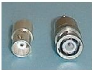
BNC konektori (do oko 300MHz ; poboljšane verzije i do reda GHz)
